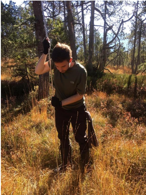
Abbildung 7: Messung der Mächtigkeit mit der Sondierstange (Quelle: eigenes Bild)
