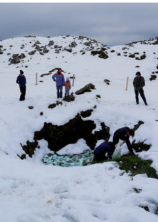
Einbringen des Tracers Tinopal CBS-X in der Hurbele auf 1676 m ü.M.
